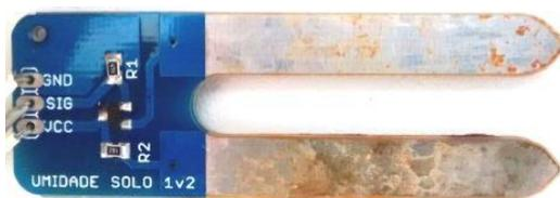
Os estudantes testavam o sensor em condição de umidade extrema, por exemplo, dentro de um copo com água, para obter um valor máximo e, por conseguinte testavam-no em areia completamente seca, com o intuito de obterem um valor mínimo para umidade. Dessa maneira, foi possível estabelecer valores ideais para o contexto abordado no projeto, como mostrado na Tabela 7.
