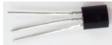
Figura 10 - Sensor de temperatura
