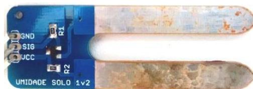
Figura 17 – Sensor de umidade do solo
