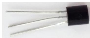
Figura 10 - Sensor de temperatura
